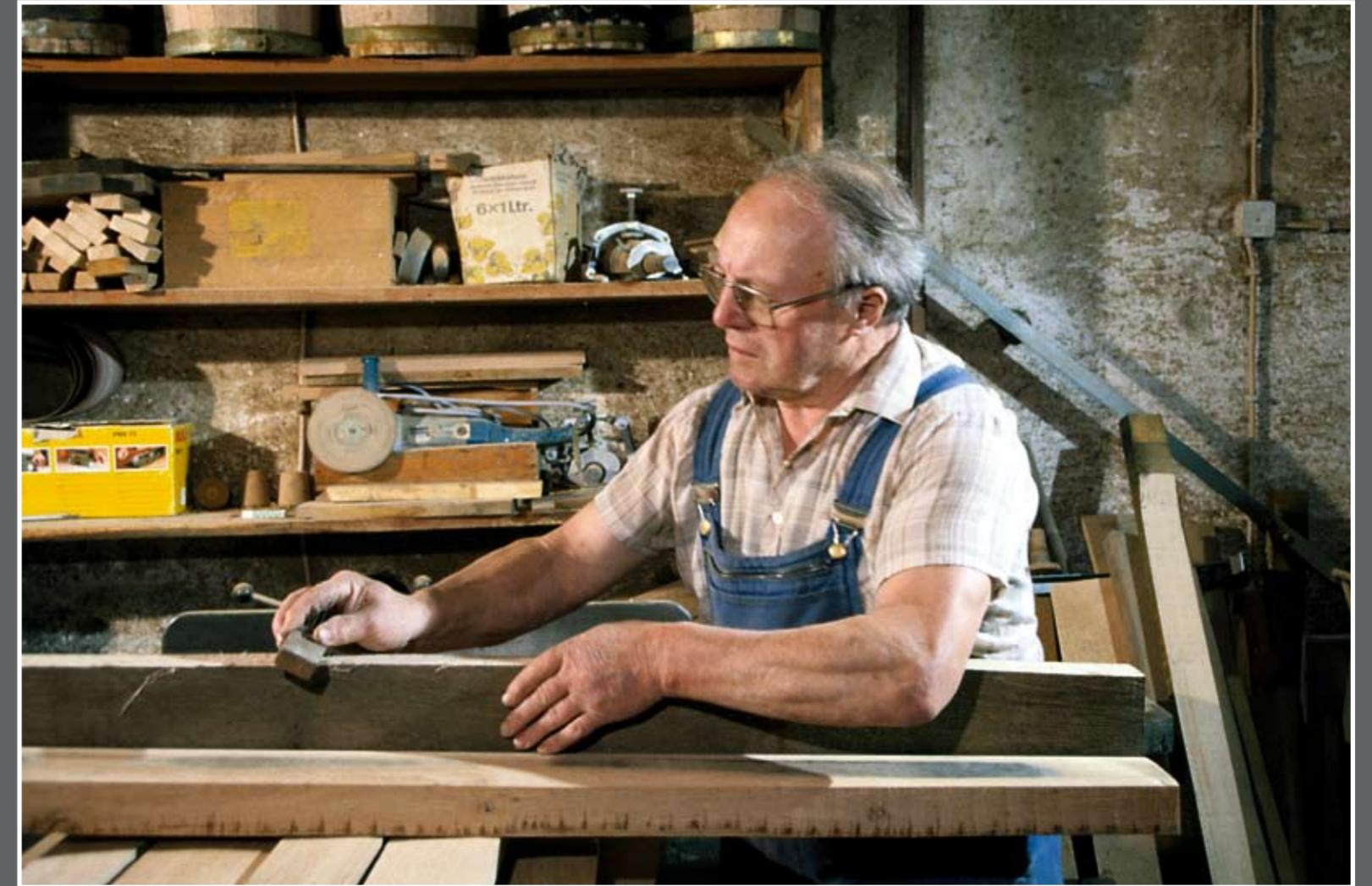
Augenmaß ist gefragt beim Hobeln einer Daube, die millimetergenau ins Gefüge des Fasses passen muß
